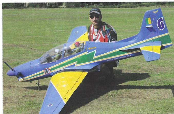
Olivier Leblond pilotait un magnifique Tucano de 2,60 m d'envergure. La machine issue d'un kit Phoenix Model affiche une masse de 13,8 kg pour une motorisation DLE 55 RA.
