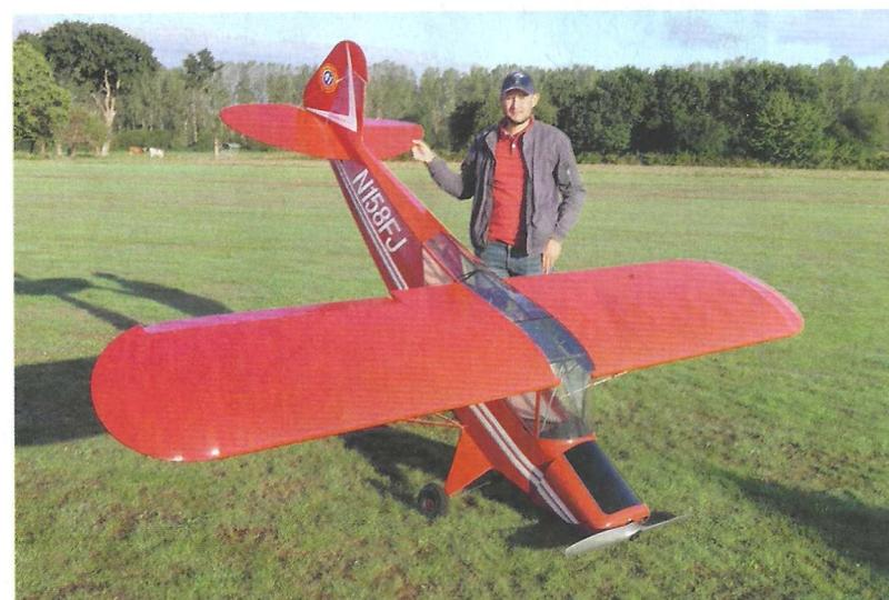
Ce fantastique Piper Cub Clipper est la propriété d'Etienne Auger. Il mesure 3,70 m d'envergure pour une masse de 12 kg. L'avion est construit en tubes de carbone. Sa propulsion est assurée par un moteur électrique réduit, il fonctionne en LiPo 10S.
