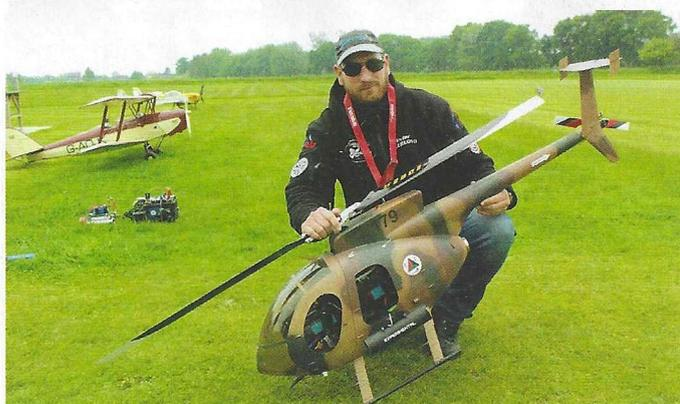
Olivier Leblond est un pilote de voiture tournante expérimenté. Il présente ce très beau MD 500 F équipé d'une mécanique T-Rex 700, alimenté en LiPo 12S. Le fuselage est commercialisé par la firme Funkey. La masse de la machine atteint les 7,2 kg.
