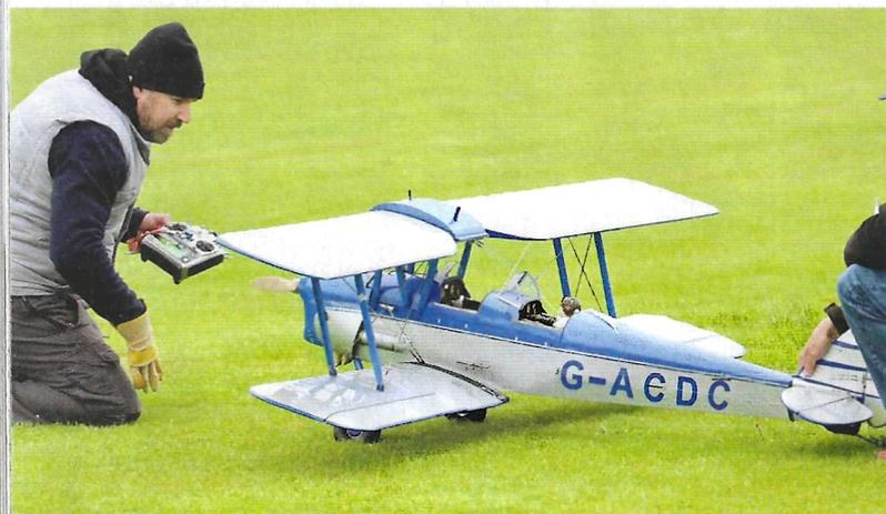
Sébastien Hémon et son magnifique Tiger Moth de 2,35 m d'envergure. Le modèle provient d'un kit ready to fly profondément remanié. Il est motorisé par un DLE 35 pour une masse de 10 kg.
