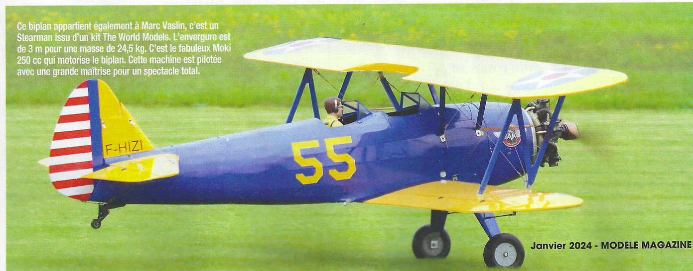
Ce biplane appartient également à Marc Vasin, c'est un Stearman issu d'un kit The World Models. L'envergure est de 3 m pour une masse de 24,5 kg. C'est le fabuleux Moki 250 cc qui motorise le biplane. Cette machine est pilotée avec une grande maîtrise pour un spectacle total.
